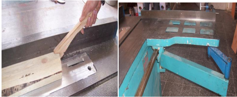
Şəkil 2.61. İtələmə çubuğu və arabalı masa
