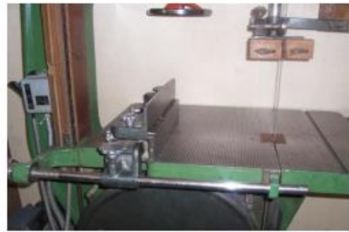
Şəkil 2.50. Masa, hasar və veriş hərəkəti
