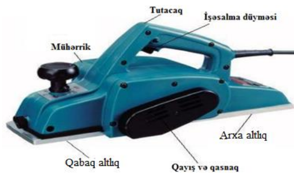
Şəkil 2.30. Əl elektrik rəndəsinin konstruktiv elementləri: 1-qabaq tutacaq, 2-qapaq, 3-mühərrik, 4-işəsalma düyməsi, 5-korpus, 6-qayış ötürməsi
