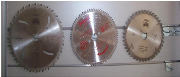
Şəkil 2.62. Dairəvi mişar dəzgahının almaz uclu dairəvi mişar diskləri
