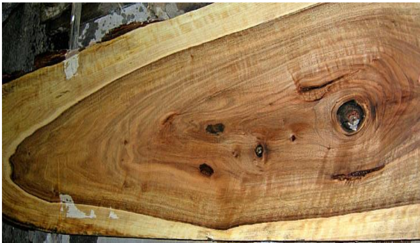
Şəkil 1.32. Ağacda qatran və çürük düyün
