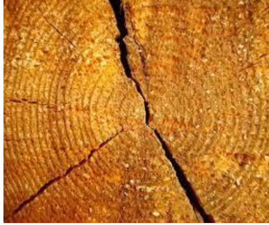
Şəkil 1.34. Oduncaqda çatlar
