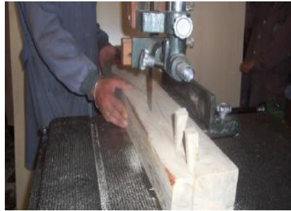
Şəkil 3.15. Əyri kəsimlərdə pazdan istifadə
