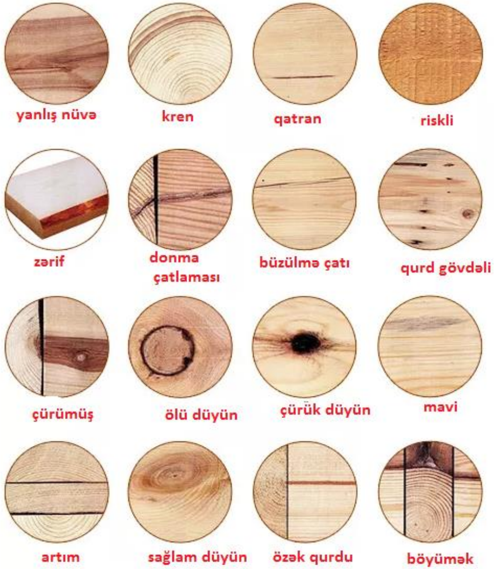
Şəkil 1.33. Müxtəlif təyinatlı qüsurların növləri
