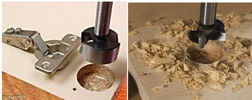
Şəkil 2.41. Forstner burğusu ilə deşik açılması
