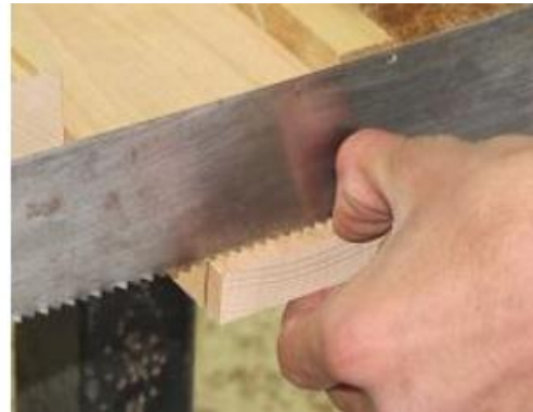
Şəkil 3.1. İş nümunəsinin bucaqlıq ilə işarələnməsi və kəsilməsi
