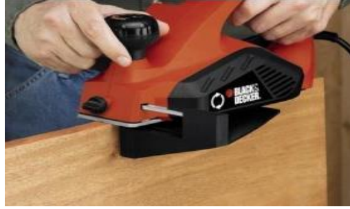
Şəkil 3.19. Əl elektrik rəndəsi ilə səthin kobud rəndələnməsi
