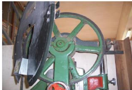
Şəkil 3.9. Qoruyucu qapaqların tənzimlənməsi
