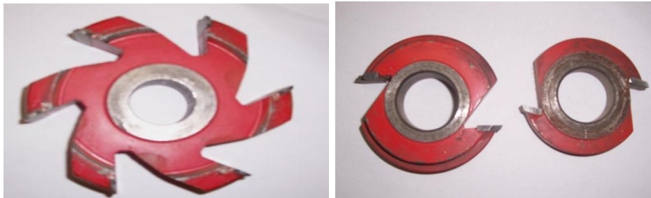
Şəkil 2.64. Dairəvi mişara taxılan diyircəkli bıçaqlar
