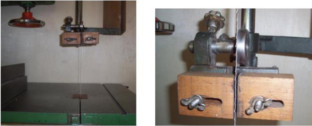
Şəkil 2.52. Lentvari mişar idarəedicisinin yerləşməsi
