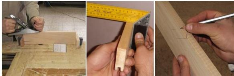
Şəkil 3.23. İş nümunəsinin yan səthinin işarələnməsi, rəndələnməsi və yoxlanılması
