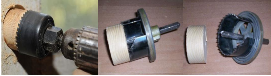
Şəkil 2.42. Deşik mişarı ilə işlərin yerinə yetirilməsi
