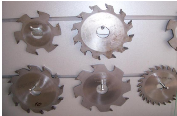
Şəkil 2.63. Almaz uclu dairəvi mişar diskinin növləri
