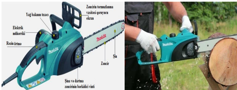
Şəkil 2.24. Zəncirli mişarın konstruktiv elementləri və zəncirli mişar vasitəsilə ağacın kəsilməsi
