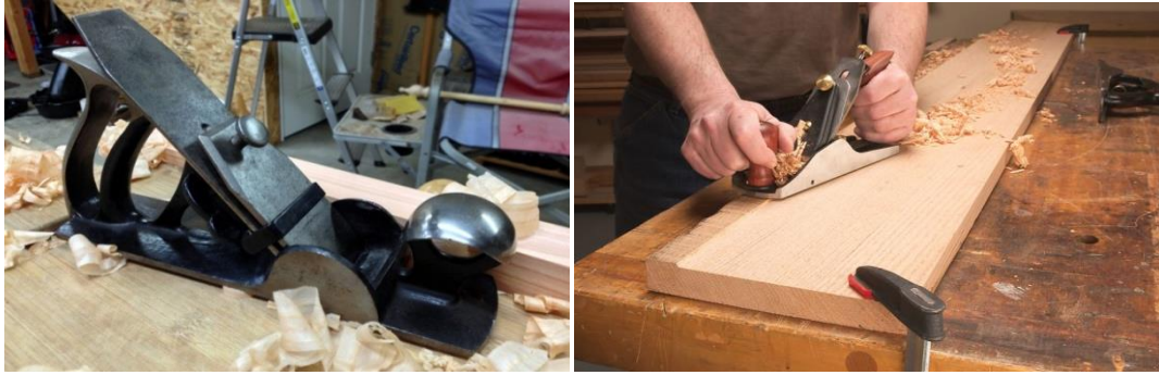
Şəkil 2.29. İş nümunəsinin rəndə ilə rəndələnməsi
