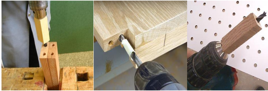
Şəkil 2.46. Dayandırma pazı və kağız bant ilə deşik dərinliyinin tənzimlənməsi
