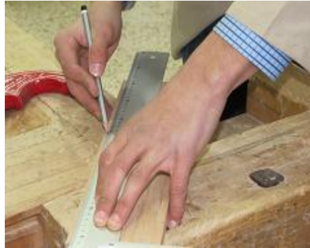
Şəkil 3.3. Nümunənin nişanlanması
