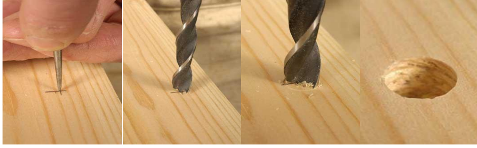
Şəkil 2.45. Deşik açma ardıcılığı
