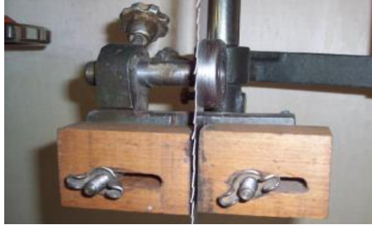
Şəkil 3.10. İdarəedici hərəkətin tənzimlənməsi
