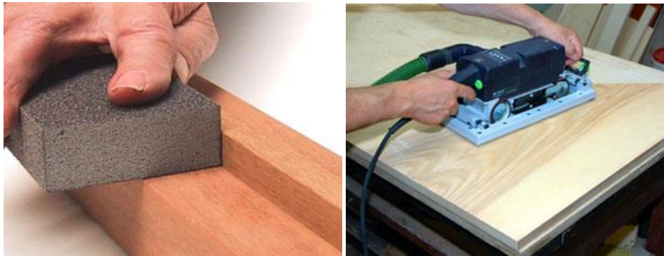
Şəkil 3.32. Ağacın, DSP və MDF materialının əl və mexaniki üsulla cilalanması
