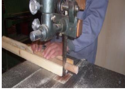
Şəkil 3.14. Dairəvi hissələrin kəsilməsi
