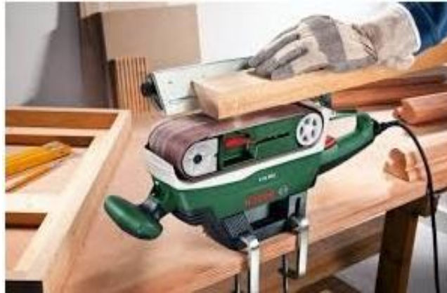
Şəkil 3.29. Lentvari cilalanma maşını ilə cilalanma
