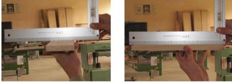
Şəkil 3.22. İş nümunəsinin günyə ilə yoxlanması
