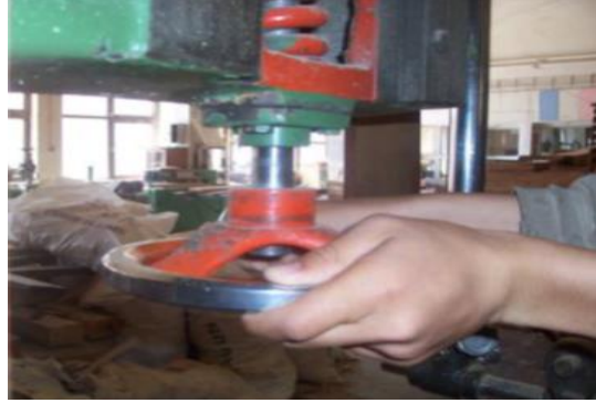
Şəkil 3.7. İşə salınmadan əvvəl dəzgahın əllə fırladılaraq yoxlanılması
