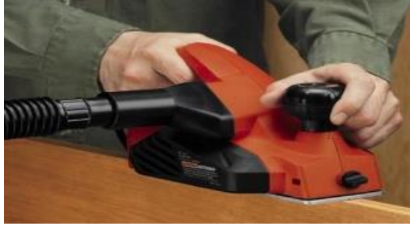
Şəkil 3.20. Əl elektrik rəndəsi ilə səthin incə rəndələnməsi
