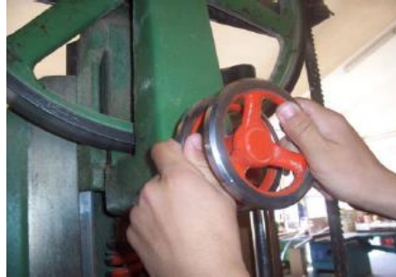
Şəkil 3.8. Qasnağa uyğun diş nizamının bağlanması
