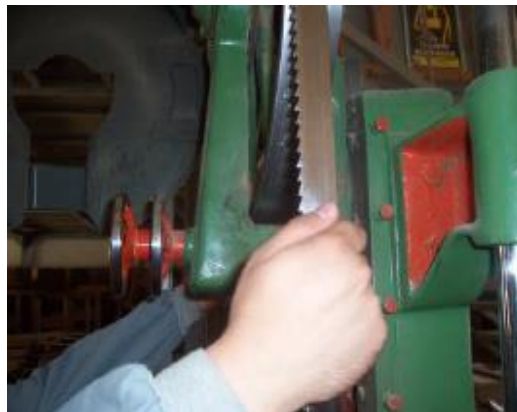
Şəkil 3.6. Üst və alt qasnağa lentvari mişar diskinin taxılması
