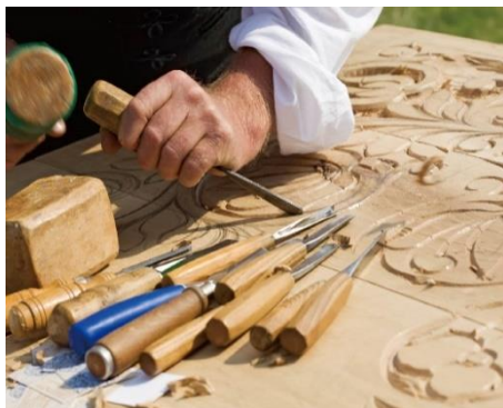
Şəkil 2.2. Kəsici qələmdən istifadə
