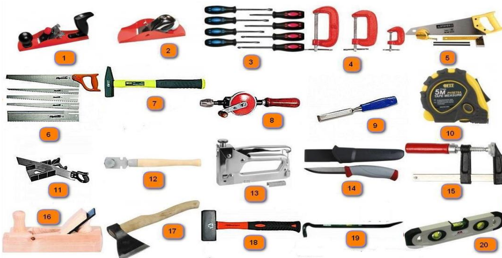
Şəkil 2.1. Dülgərlik işində istifadə edilən alətlər: 1-metal rəndə; 2-kiçik rəndə; 3-yiv açan; 4-qisim; 5-əl mişarı; 6-qarışiq mişarlar; 7-çəkic ; 8-əl burğusu; 9-iskənə; 10-rulet; 11-kəsici; 12-şüşə kəsici; 13- stepler; 14-dülgər bıçağı; 15-fstrubsin; 16-taxta rəndə; 17-balta; 18-kuvald; 19-mismar çıxaran; 20-taraz.
