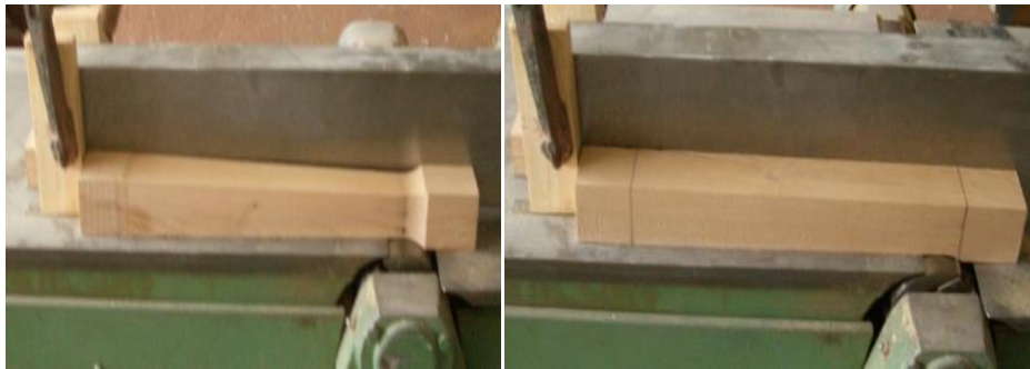
Şəkil 3.18. Parçanın ayaq hissəsinin rəndələnməsi
