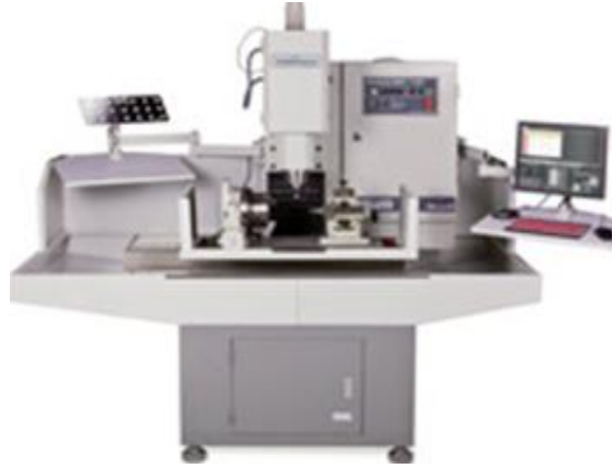
Şəkil 2.75. PCNC (Personal Computer Numerical Control) fərdi kompüterlə rəqəmli idarəetmə
