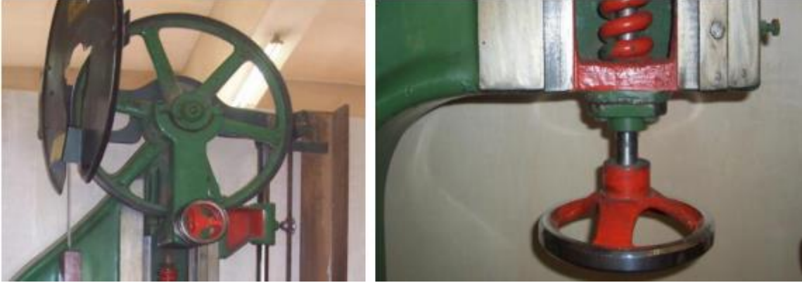
Şəkil 2.51. Üst qasnaq, qabaq və arxaya əymə, gərginlik tənzimləmə qolu
