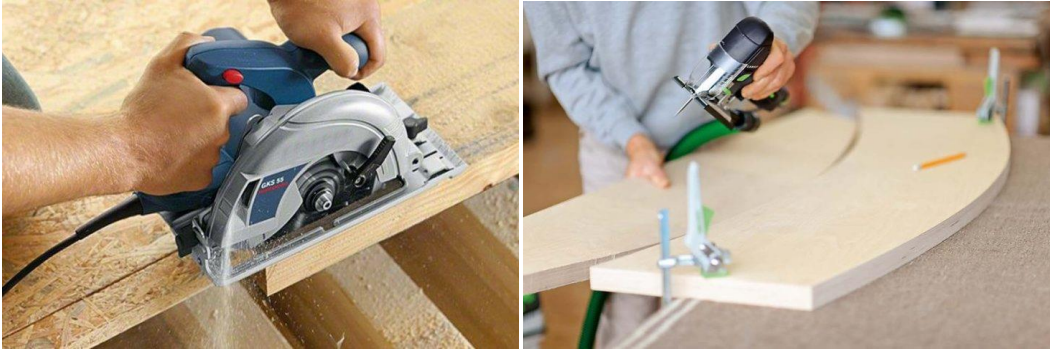
Şəkil 2.25. Dairəvi diskli mişar və lobzik vasitəsilə kəsmə əməliyyatı
