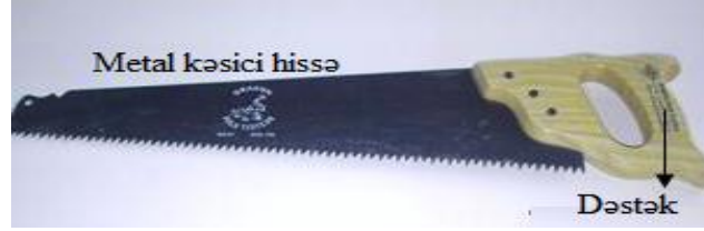
Şəkil 2.21. Mişarın kəsici hissəsi və dəstəyi
