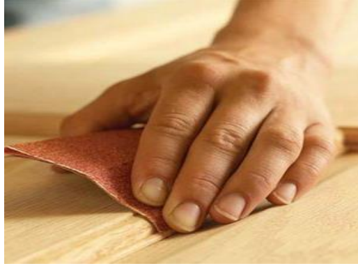
Şəkil 3.31. Ağac məmulatının əl ilə cilalanması
